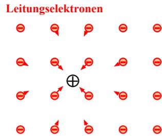
Abbildung 5.36: Abschirmung einer positiven Ladung durch die Leitungselektronen.
