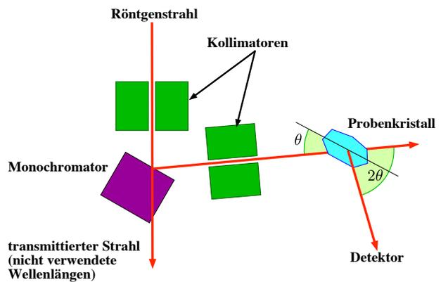
Abbildung 2.85: Drehkristall-Verfahren.
