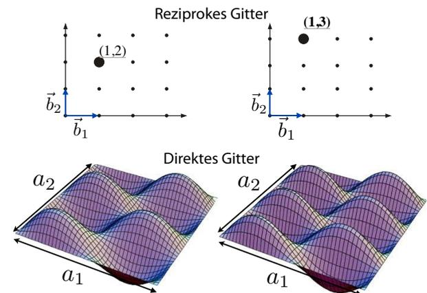
Abbildung 2.71: Punkte im reziproken Gitter und ihre Fouriertransformierten.
