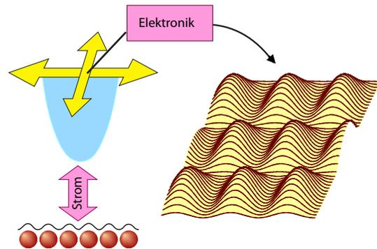
Abbildung 2.57: Funktionsprinzip der Rastertunnelmikroskopie.
