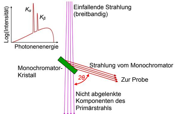
Abbildung 2.80: Filterung der Röntgenstrahlung in einem Monochromator.
