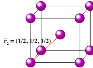
Abbildung 2.90: Einheitszelle des kubisch innerzentrierten Gitters.
