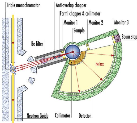
Abbildung 2.65: Neutronen-Flugzeitspektrometer IN6 am ILL Grenoble.
