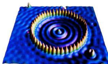
Abbildung 2.58: STM Bild eines Kreises aus 48 Eisenatomen.
