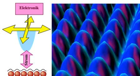
Abbildung 2.3: Prinzip der Raster-Tunnelmikroskopie und damit gemessene Ni-Atome.
