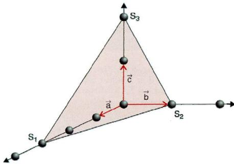
Abbildung 2.35: Netzebene in 3D; Achsenabschnitte 3, 1, 2.
