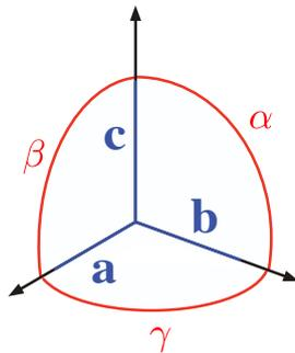
Abbildung 2.27: Definition der Achsen und Winkel.
