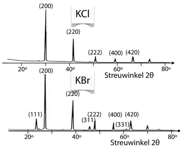
Abbildung 2.95: Vergleich der Beugungsreflexe von KCl und KBr.
