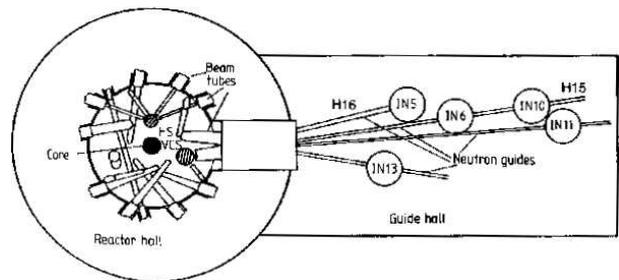
Abbildung 2.64: Erzeugung von Neutronen im Forschungsreaktor (ILL Grenoble).
