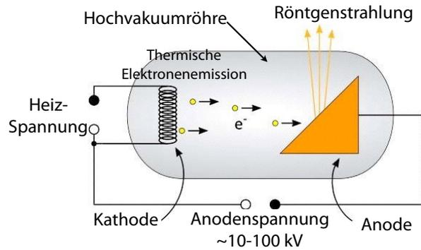
Abbildung 2.79: Erzeugung von Röntgenstrahlung in einer Röntgenröhre.
