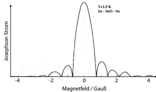
Abbildung 9.45: Abhängigkeit des Josephson Stroms von der Flussdichte.
