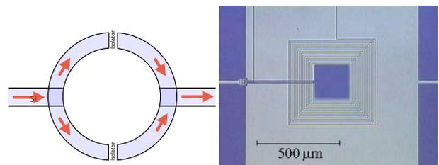
Abbildung 9.46: Schematischer Aufbau und Bild eines SQUIDs.
