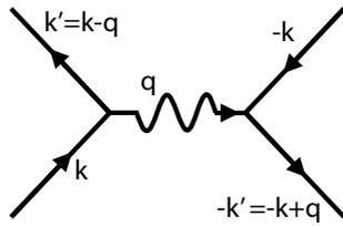
Abbildung 9.33: Wechselwirkung durch Emission und Absorption eines Phonons.
