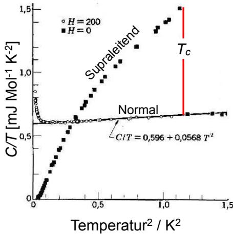
Abbildung 9.19: Temperaturabhängige spezifische Wärme von Gallium. [12]
