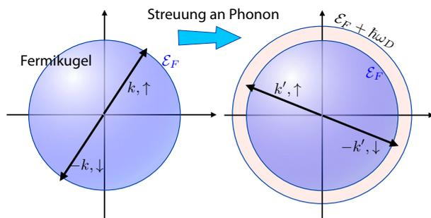
Abbildung 9.32: Streuung eines Elektronenpaares mit einem Phonon.
