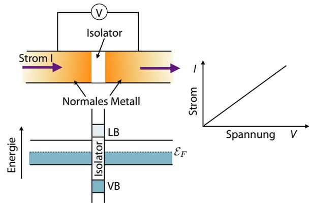
Abbildung 9.38: Tunnelkontakt zwischen zwei Normalleitern.
