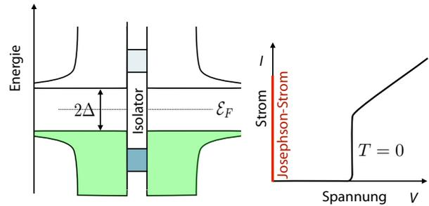
Abbildung 9.41: Zustandsdichten an einem Josephson Kontakt und Strom-Spannung Kennlinie.
