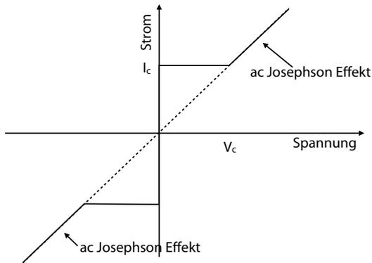
Abbildung 9.43: Strom-Spannung Kurve bei einem Josephson Kontakt.
