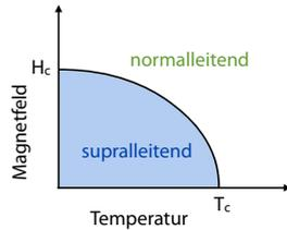
Abbildung 9.8: Zustandsdiagramm und kritische Temperatur einiger Supraleiter.
