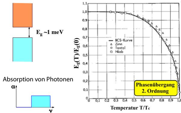
Abbildung 9.22: Energielücke, Temperaturabhängigkeit und Absorptionsspektrum.
