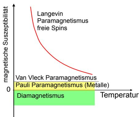
Abbildung 8.24: Vergleich der temperaturabhängigen Suszeptibilität von unterschiedlichen Materialtypen.
