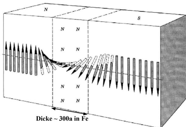
Abbildung 8.79: Änderung der Spin-Orientierung im Bereich der Bloch-Wand.
