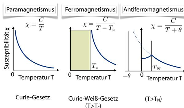
Abbildung 8.66: Temperaturabhängigkeit der Suszeptibilität für unterschiedliche magnetische Ordnung.
