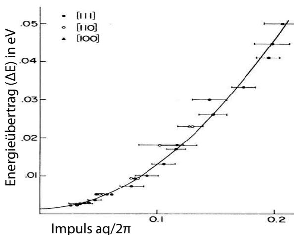
Abbildung 8.53: Dispersionsrelation der Spinwellen in  $\text{Co}_{92}\text{Fe}_8$ . [14]
