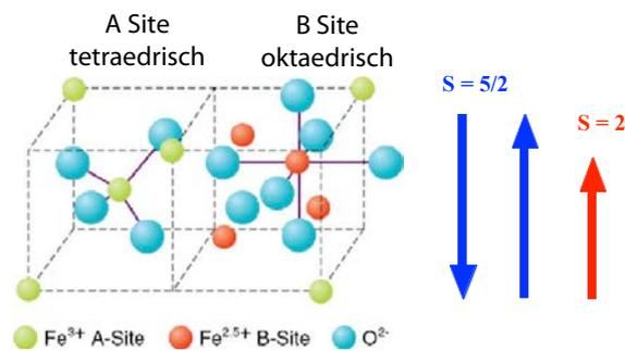
Abbildung 8.64: Struktur und magnetische Ordnung in  $\text{Fe}_2\text{O}_3$ .
