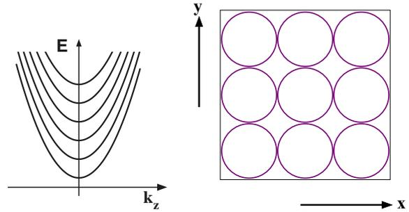
Abbildung 8.28: Energien und Bahnkurven von Landau-Zuständen.
