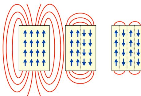
Abbildung 8.76: Reduktion der magnetischen Feldenergie durch Domänenbildung.
