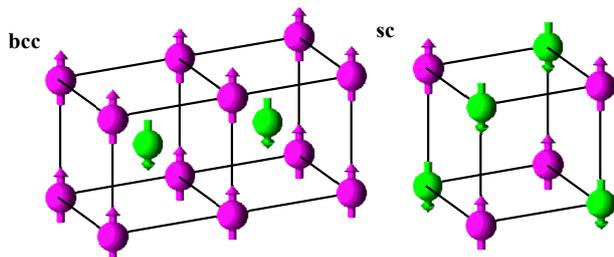
Abbildung 8.60: Antiferromagnetische Ordnung im bcc und sc Gitter.
