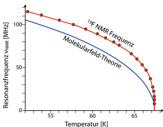
Abbildung 8.70: Resonanzfrequenz der <sup>19</sup>F Kernspins in MnF<sub>2</sub> als Funktion der Temperatur.
