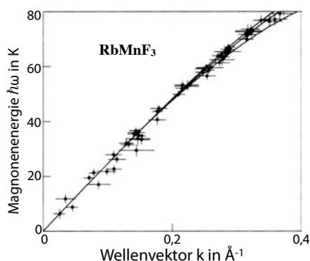
Abbildung 8.69: Magnonendispersion in RbMnF<sub>3</sub>.
