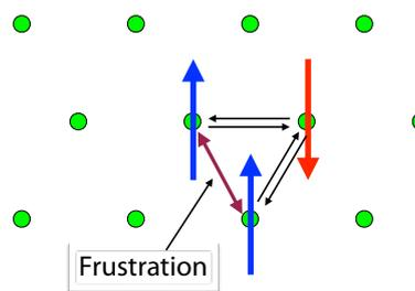
Abbildung 8.61: Frustrierte antiferromagnetische Ordnung im hexagonalen Gitter.
