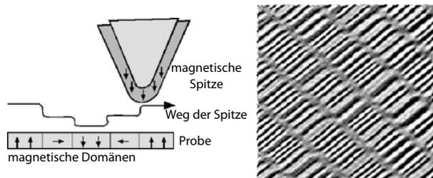
Abbildung 8.90: Links: Prinzip der magnetischen Kraftmikroskopie. Rechts: Strukturen auf einer Festplatte.
