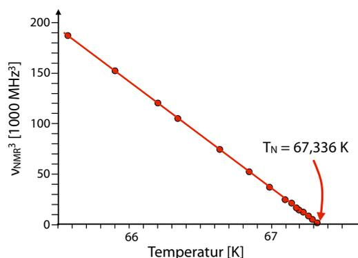
Abbildung 8.71: Resonanzfrequenz der <sup>19</sup>F Kernspins in MnF<sub>2</sub> als Funktion der Temperatur.
