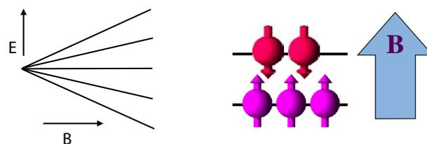
Abbildung 8.16: Energie und Besetzungszahlen der Spin-Zustände im Magnetfeld.
