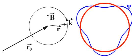
Abbildung 8.26: Links: Kreisbahn senkrecht zum Magnetfeld. Rechts: Bahn-Quantisierung.
