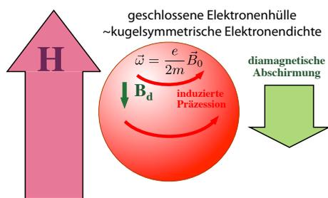
Abbildung 8.4: Diamagnetische Abschirmung.
