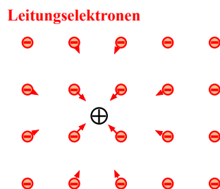
Abbildung 5.36: Abschirmung einer positiven Ladung durch die Leitungselektronen.
