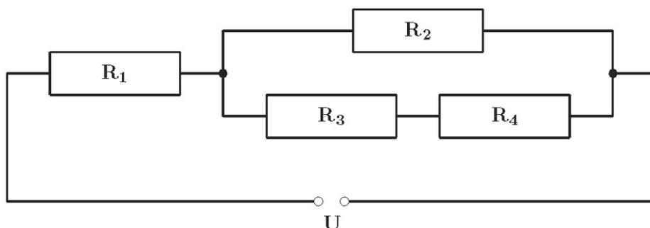
Die Berechnung des Ersatzwiderstandes erfolgt nach dem „Bottom-Up-Prinzip“. Man berechnet – beginnend mit den Einzelwiderständen – für immer größere Teile der Schaltung den jeweiligen Ersatzwiderstand. Dabei benötigt man die Formeln für den Ersatzwiderstand bei Reihen- und Parallelschaltung (Aus der Vorlesung (Kapitel 4.6.2) wissen wir bei Parallelschaltung addieren sich die Widerstände reziprok, bei Reihenschaltung hingegen direkt.)
