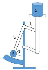
Drehmomentgleichgewicht zwischen Zeiger F und Last G. Der Bezugspunkt ist der Schnittpunkt von  $I_1$  und  $I_2$ . Der Winkel zwischen Schwerkraft und  $I_2$  ist  $\varphi$ .
