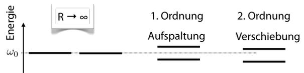
Abbildung 9.50: Energieverschiebung durch die Kopplung.
