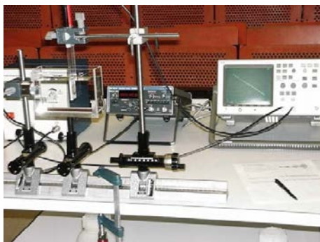
Abbildung 6.19: Messung der Schallgeschwindigkeit.
