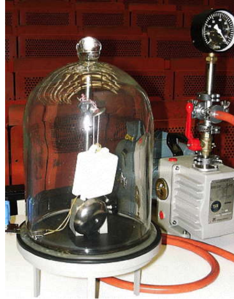
Abbildung 6.26: Klingel in einem Vakuumbehälter.
