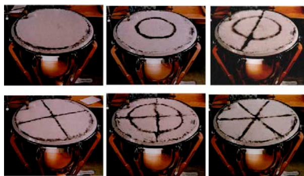
Abbildung 6.38: 6 unterschiedliche Moden als Chladni'sche Klangfiguren [aus Spektrum der Wissenschaft].
