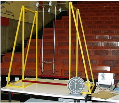
Abbildung 5.53: Zwei gekoppelte Pendel.
