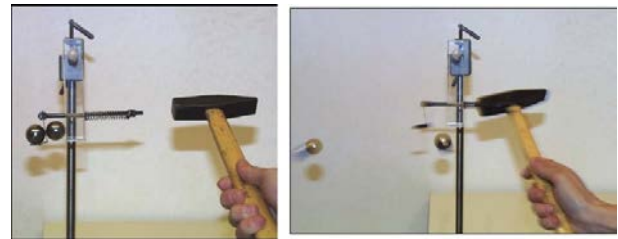
Abbildung 2.14: Unabhängigkeitsprinzip: Eine Kugel wird fallen gelassen, die andere gleichzeitig horizontal geworfen. Beide treffen gleichzeitig am Boden auf.
