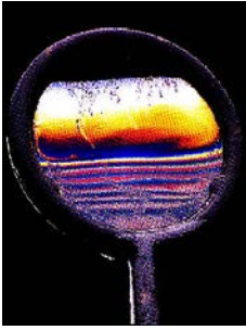
Abbildung 4.115: Interferenz an einer Seifenlamelle erzeugt farbige Streifen.
