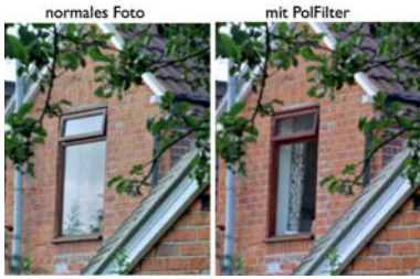
Abbildung 4.51: Eliminierung von Reflexen mit Hilfe eines Polarisationsfilters.
