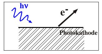
Man kann die emittierten Elektronen auf einer Anode einfangen und den so erzeugten Photostrom direkt messen. Dafür muß sich das Elektrodenpaar im Vakuum befinden.
