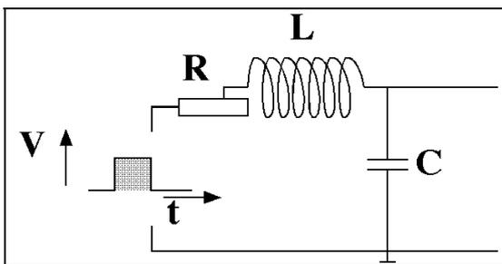
Als ein Beispiel für gedämpfte Schwingungen betrachten wir den LRC Schwingkreis. Er kann abgeleitet werden aus dem LC Kreis. Durch Zufügen eines Ohm'schen Widerstandes (der in jedem Schwingkreis existiert) erhält man eine modifizierte Maschenregel:
