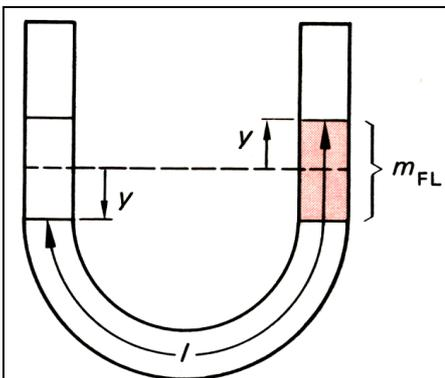
Wir betrachten eine Flüssigkeitssäule in einem U-Rohr. Sind beide Enden auf gleicher Höhe so ist das System im Gleichgewicht. Ist die Säule um  $y$  verschoben, so entsteht eine rüctreibende Gewichtskraft. Die Bewegungsgleichung enthält die Gesamtmasse  $m$  der Flüssigkeit
