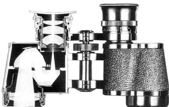
Abbildung 5.93: Strahlengang durch ein Fernglas.
