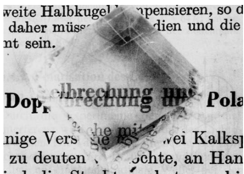
Abbildung 5.98: Doppelbrechung in einem Kalkspat-Kristall.
