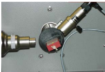
Abbildung 5.151: Einfache Laue Kamera.
