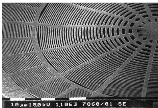
Abbildung 5.147: Fresnel'sche Zonenplatte als Linse für Atome.
