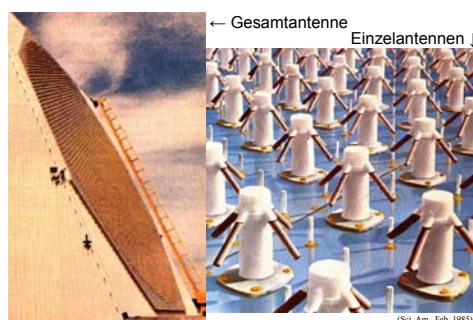
Abbildung 5.121: Phased-Array Radar Antenne.
