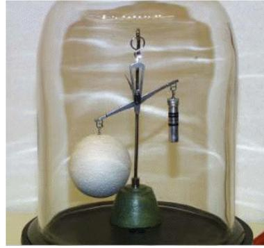
Abbildung 2.91: Auftriebswaage.
