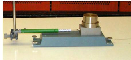
Abbildung 2.21: Messung des Reibungswiderstandes mit Hilfe eines Federkraftmessers.
