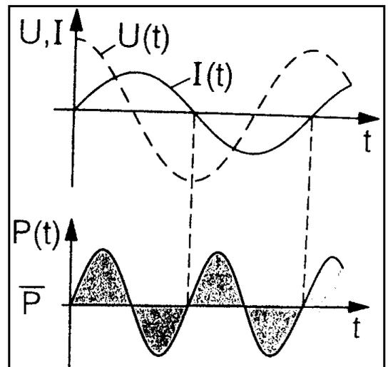
d.h. es wird keine mittlere Arbeit geleistet. Die momentane Leistung  $P(t)$  ist während einer Periode gleich lang positiv wie negativ. Ein idealer Transformator z.B., der im Leerlauf betrieben wird, zieht keine Leistung. Allerdings sind in den Zuleitungen Strom und (Verlust-)Spannung nicht notwendigerweise außer Phase, so, dass trotzdem Verluste auftreten.
