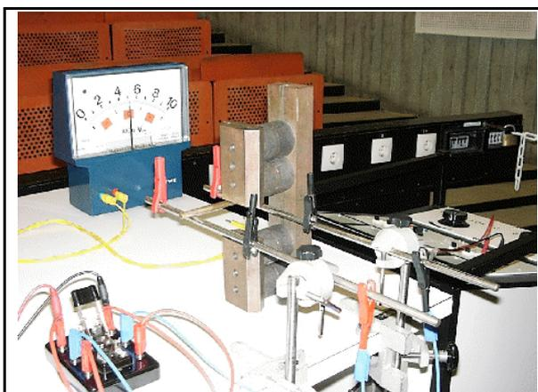
Eine andere Variante besteht darin, eine Leiterschleife zu verwenden, welche aus zwei festen und einem rollenden Kupferstab gebildet wird. Ein Permanentmagnet sorgt für den Fluss durch diese Spule.
