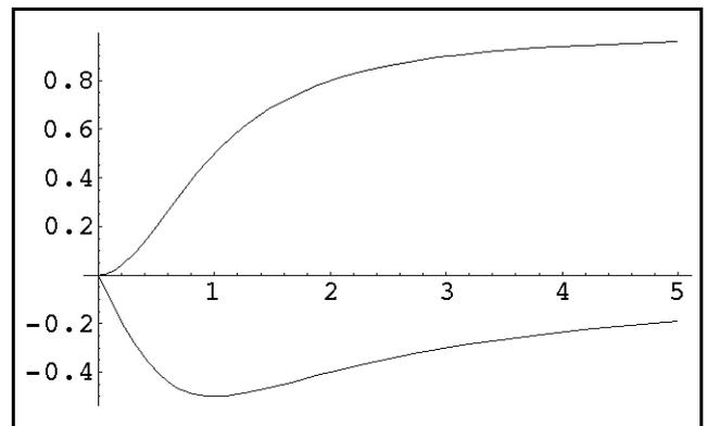
Dieses Resultat kann qualitativ leicht nachvollzogen werden: Ein Gleichstrom kann nicht durch den Kondensator fließen, für hohe Frequenzen wirkt der Kondensator dagegen wie ein Kurzschluss.
