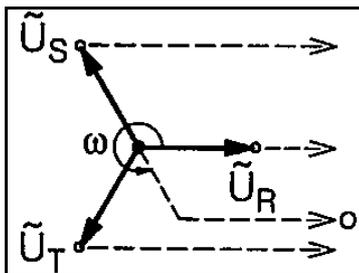
Diese drei Phasen können als komplexe Amplituden dargestellt werden. In Europa ist die Frequenz  $\omega = 2\pi \cdot 50 \text{ Hz}$ , die Amplitude  $U_0 = 340 \text{ V}$ .
