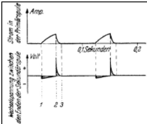
Die wird z.B. beim Funkeninduktor verwendet, wo man zunächst einen Strom durch die Spule fließen läßt, der dann plötzlich unterbrochen wird. Im Magnetfeld in der Spule ist jedoch eine erhebliche Energie gespeichert, die nach außen abgeführt werden muss. Dies geschieht in diesem Beispiel über eine Funkenstrecke. Dieses Prinzip wird z.B. in Benzinmotoren zur Erzeugung des Zündfunken im Zylinder verwendet.
