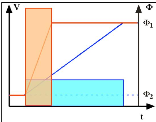
Steigt der Fluss durch die Leiterschleife linear mit der Zeit so misst man eine Spannung, die während dieser Zeit konstant ist. Je schneller das Magnetfeld steigt, desto höher ist die Spannung. Das Integral  $\int U dt$ , in diesem Fall  $U \cdot t$ , ist jedoch unabhängig von der Rate und nur durch die Flussdifferenz  $\Delta \Phi$  zwischen Anfangs- und Endwert gegeben,
