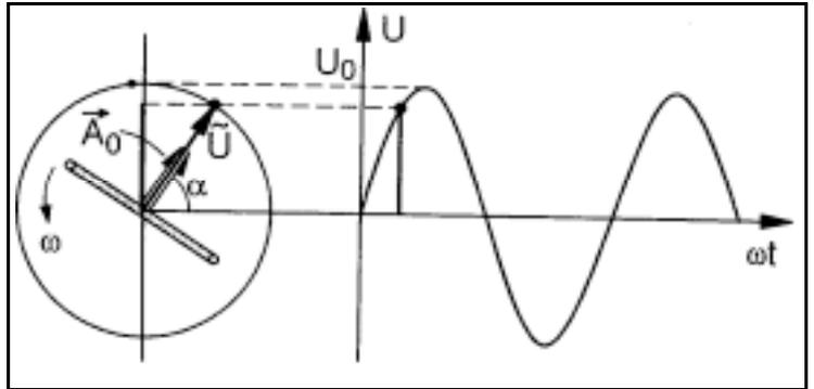
dargestellt. Meist rechnet man nur mit der komplexen Amplitude  $U_0 e^{i\alpha}$ . Die Realteile werden auch als Wirkanteile, die Imaginärteile als Blindanteile bezeichnet.
