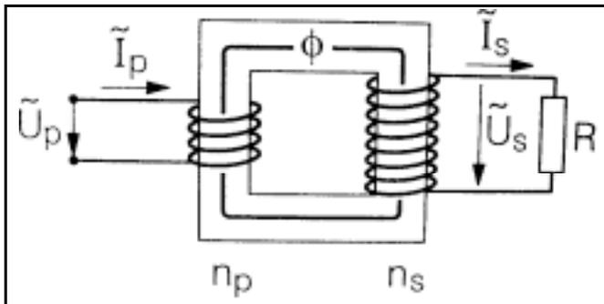
Man bringt dazu einen Eisenkern in eine Spule, durch die ein Wechselstrom fließt. Der dadurch induzierte magnetische Fluss kann über das Induktionsgesetz berechnet werden:
