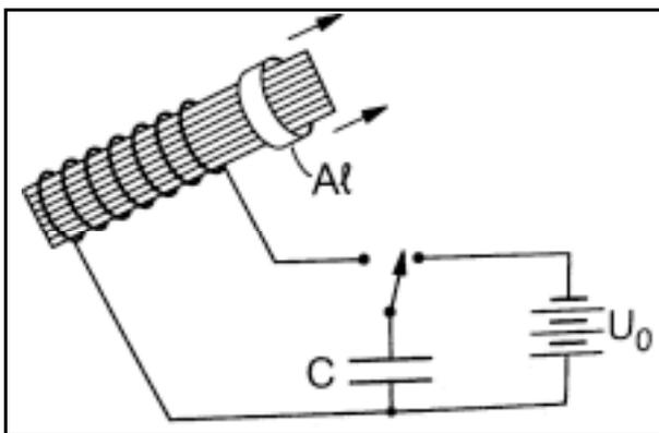
Eine Leiterspule aus Aluminium wird um einen Eisenkern gelegt, in dem mit Hilfe einer Induktionsspule ein wechselndes Magnetfeld erzeugt wird. Man beobachtet,
