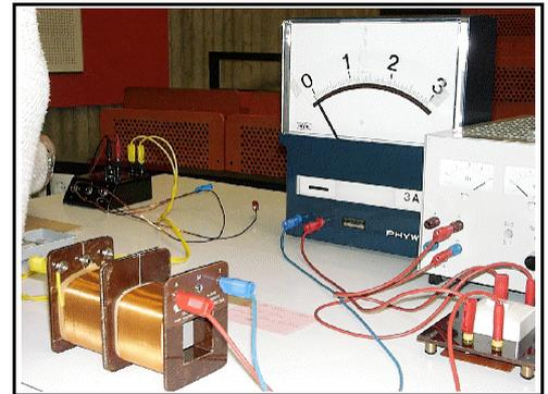
Eine etwas andere Möglichkeit, die Flussdichte zu ändern, basiert auf dem vorher gezeigten qualitativen Experiment, dass man einen Magneten mehr oder weniger weit in die Leiterschleife hinein schiebt.
