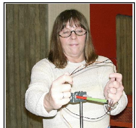
Dieses Experiment kann auch anders interpretiert werden: Man bewegt den Leiter der Länge  $\ell$  durch das Magnetfeld; dabei werden die darin enthaltenen Ladungsträger durch die Lorentzkraft zur Seite gedrückt, so, dass eine Spannung entsteht, welche gerade die Lorentzkraft kompensiert.
