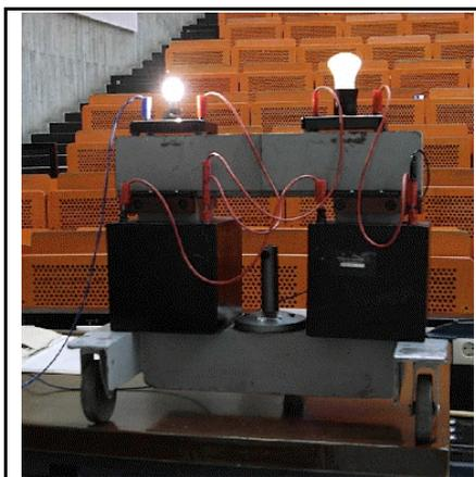
Spule  $L_1$  nach Durchschalten des Schalters ein konstanter Strom von 5 A. Unmittelbar nach Einschalten wächst der Strom durch die Spule, während der Strom durch die Lampe  $L_2$  abnimmt. Beim Öffnen des Schalters löscht  $L_1$  aus, während die Lampe  $L_2$  noch brennt: die im Magnetfeld der Spule enthaltene Energie wird durch diese Lampe entladen.
