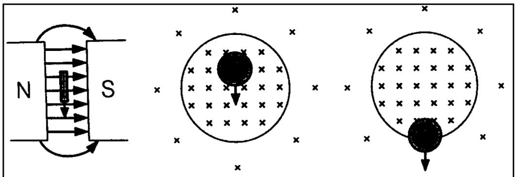
Im Magnetfeld fällt sie mit normaler Geschwindigkeit. Am unteren Ende des Magnetfeldes wird es wieder stark verlangsamt. Der Effekt zeigt eine gewisse Analogie zum Meissner-Effekt: Auch hier verzögern die Wirbelströme das Eindringen des Magnetfeldes in das Leitermaterial. Allerdings kann dies für normal leitende Materialien nur eine Verzögerung bewirken, da die Verluste im Leiter ein Abklingen der Oberflächenströme bewirken.
