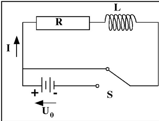
Legt man an eine Spule eine Spannung an so folgt der Strom verzögert. Wir berechnen hier das Ausschaltverhalten: Wenn die Batterie überbrückt ist muss die Summe der Spannung über der Spule und der Spannung über dem Widerstand gleich sein:
