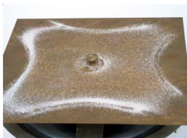
Abbildung 6.34: Beispiel einer Chladni'schen Klangfigur.
