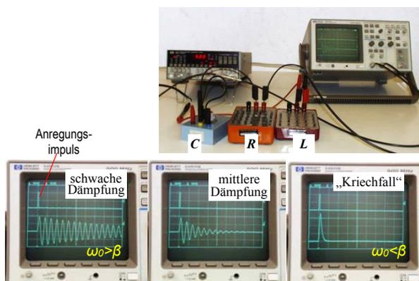
Abbildung 5.38: Unterschiedlich starke Dämpfung in einem RLC-Schwingkreis.
