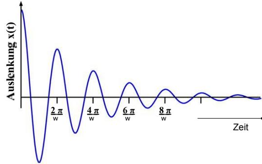
Abbildung 5.35: Gedämpfte Schwingung.
