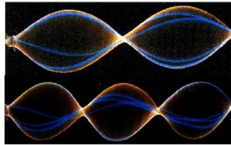
Abbildung 5.58: Unterschiedliche Eigenmoden einer eingespannten Saite.
