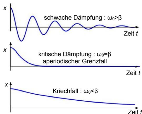
Abbildung 5.40: Zusammenfassung der drei Bereiche der Dämpfung.
