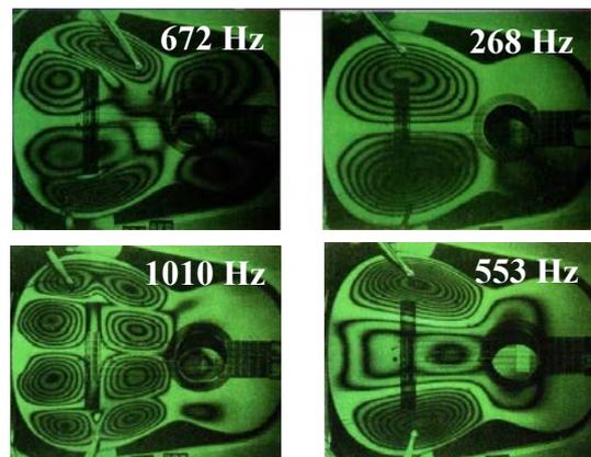
Abbildung 5.62: Schwingungsmoden einer Gitarre.
