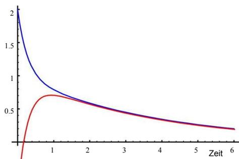
Abbildung 5.39: Zeitabhängigkeit im Bereich der überkritischen Dämpfung.
