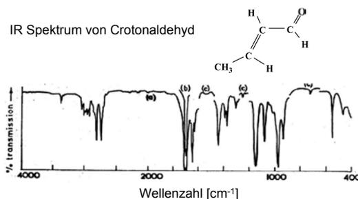
Abbildung 5.6: Infrarotspektrum von Crotonaldehyd.
