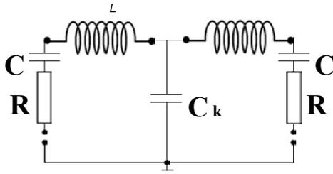
Abbildung 5.55: Gekoppelte elektrische Schwingkreise.
