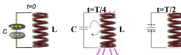
Abbildung 5.32: Energieformen im LC-Schwingkreis.
