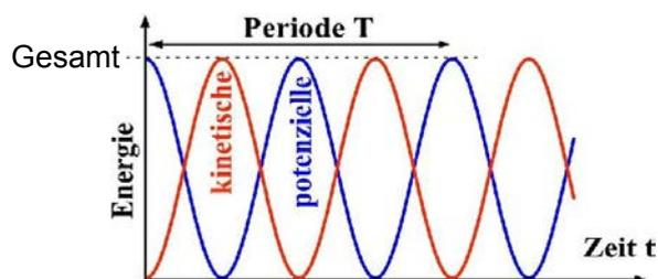
Abbildung 5.18: Kinetische und potenzielle Energie als Funktion der Zeit.
