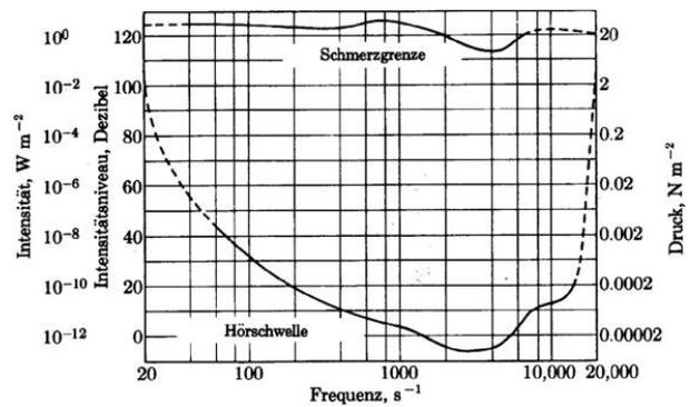
Abbildung 5.61: Hörschwelle und Schmerzgrenze des menschlichen Ohrs als Funktion der Frequenz.
