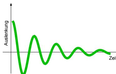
Abbildung 5.10: Gedämpfte Schwingung.
