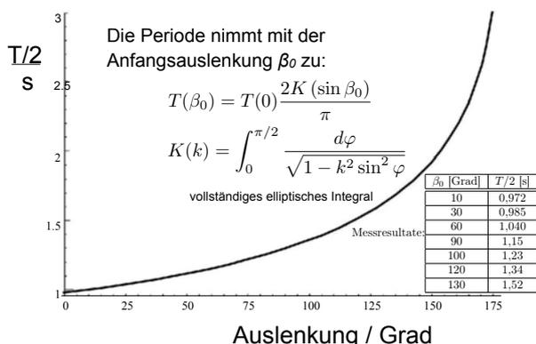
Abbildung 5.21: Periodendauer des anharmonischen Oszillators als Funktion der Auslenkung.
