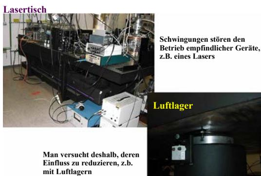
Abbildung 5.4: Unterdrückung von störenden Schwingungen in einem Laserlabor.
