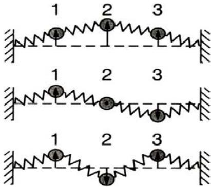
Abbildung 5.57: Unterschiedliche Moden einer Transversalschwingung.
