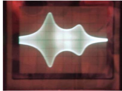
Abbildung 5.56: Gemessene Anregungsamplitude als Funktion der Frequenz.
