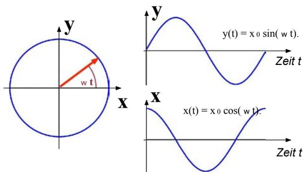
Abbildung 5.22: Kreisbewegung und Zeitabhängigkeit der beiden Quadraturkomponenten.
