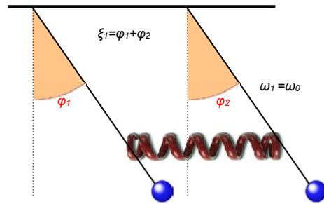
Abbildung 5.52: Eine der Eigenmoden des Systems.
