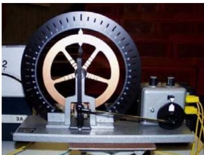
Abbildung 5.42: Pohl'sches Rad: Torsionschwinger mit äußerem Antrieb.
