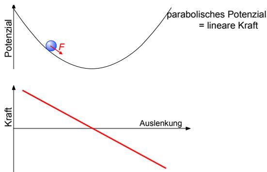
Abbildung 5.15: Potenzial und Kraft als Funktion der Auslenkung.
