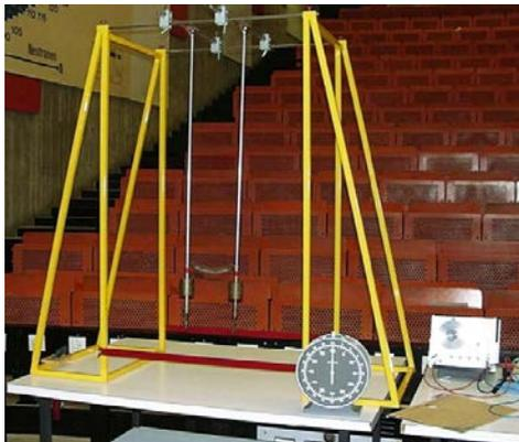
Abbildung 5.50: Zwei gekoppelte Pendel.
