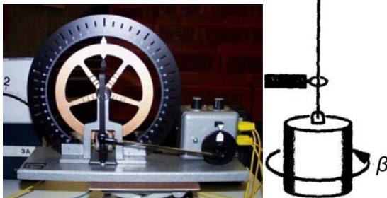
Abbildung 5.26: 2 Torsionsschwinger: Pohl'sches Rad mit Spiralfeder und Trommel an Draht aufgehängt.
