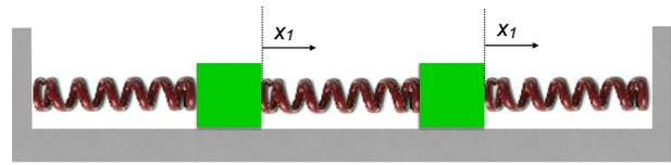
Abbildung 5.51: 2 gekoppelte Massenpunkt.
