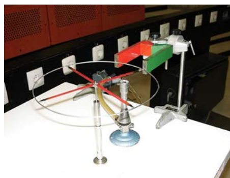
Abbildung 4.144: Änderung der magnetischen Eigenschaften bei der Curie-Temperatur.
