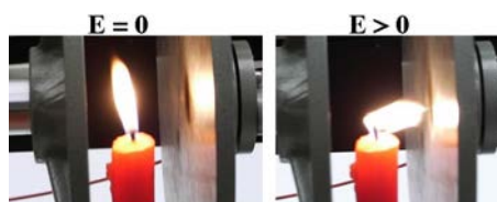
Abbildung 4.29: Kerzenflamme in einem elektrischen Feld.
