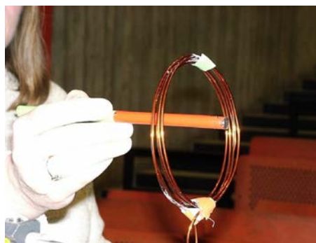
Abbildung 4.163: Ein Magnet wird in eine Leiterschleife geschoben und induziert dadurch eine Spannung.
