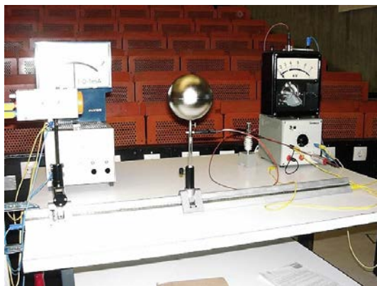
Abbildung 4.10: Messung des Coulomb-Feldes.
