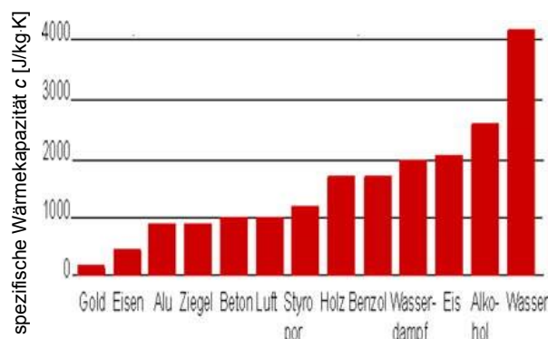
Abbildung 3.12: Spezifische Wärmekapazität unterschiedlicher Materialien.
