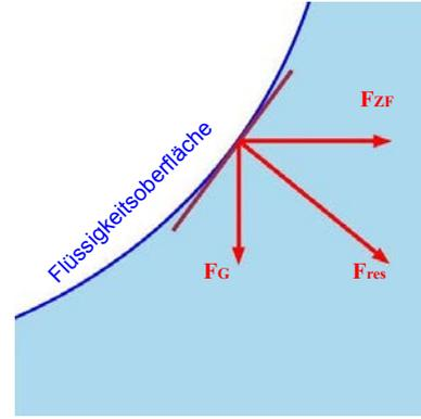
Abbildung 2.109: Kräftegleichgewicht an der Flüssigkeitsoberfläche.
