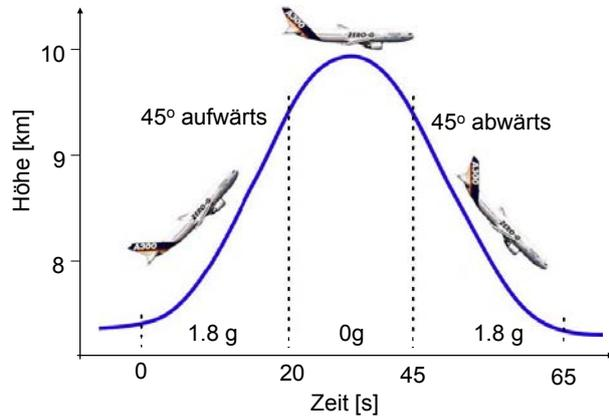
Abbildung 2.103: Prinzip des Parabelflugs.
