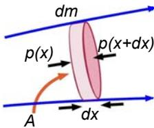
Abbildung 2.151: Druckkraft auf dünne Flüssigkeitsscheibe.
