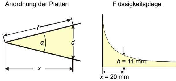
Abbildung 2.142: Kapillarkräfte zwischen 2 Glasplatten.
