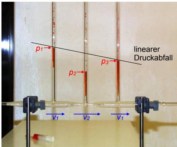
Abbildung 2.154: Experimentelle Verifizierung der Bernoulli-Gleichung.
