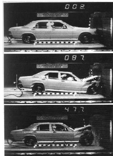
Abbildung 2.60: Unelastischer Stoß eines Automobils.
