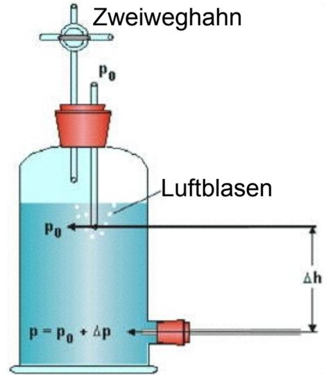
Abbildung 2.166: Verifizierung des Gesetzes von Hagen-Poiseuille. Die Anordnung stellt sicher, dass der Druck beim Ausfluss konstant ist, auch wenn die Flüssigkeitsoberfläche sinkt.
