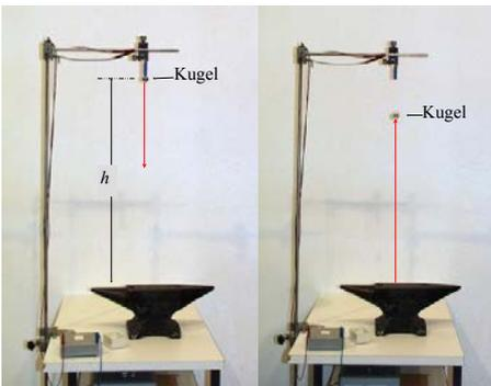
Abbildung 2.53: Kugel springt auf einem Amboss.
