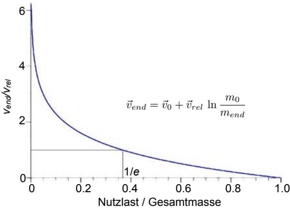
Abbildung 2.34: Endgeschwindigkeit der Rakete als Funktion der Nutzlast.
