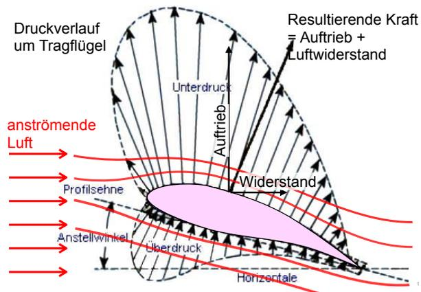
Abbildung 2.169: Auftrieb an einem Flugzeugflügel.
