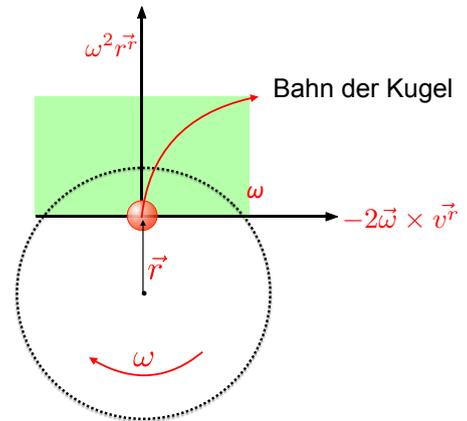
Abbildung 2.112: Zentrifugal- und Corioliskraft im Drehstuhl.
