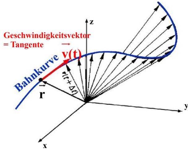
Abbildung 2.9: Bahnkurve in 3D.
