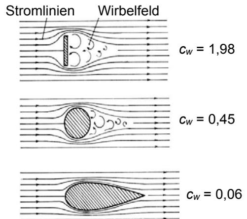
Abbildung 2.163: Widerstandsbeiwerte für unterschiedliche Körper.
