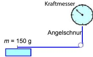
Abbildung 2.107: Messung der Zentrifugalkraft auf eine rotierende Masse.
