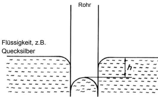
Abbildung 2.143: Kapillardepresseion
