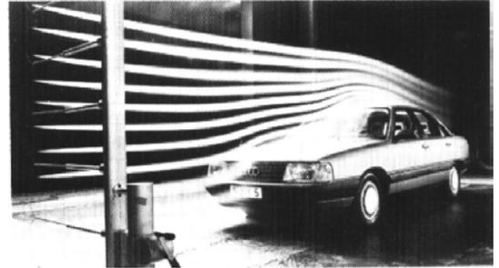
Abbildung 2.147: Automobil im Windkanal.
