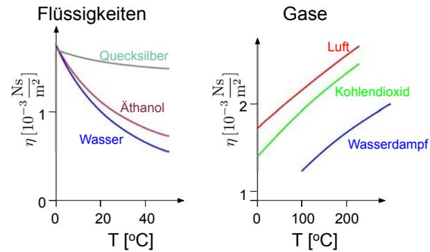
Abbildung 2.161: Temperaturabhängigkeit der Viskosität von Flüssigkeiten und Gasen.
