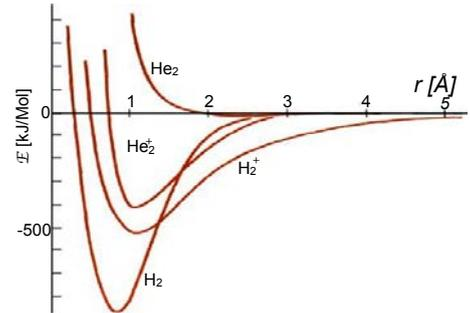
Abbildung 2.47: Potenzielle Energie einfacher 2-atomiger Moleküle als Funktion des atomaren Abstandes.
