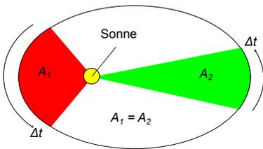
Abbildung 2.96: 2. Kepler'sches Gesetz: Die Flächen  $A_1$  und  $A_2$  sind gleich.
