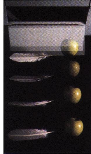
Abbildung 2.24: Freier Fall eines Apfels und deiner Feder im Vakuum.
