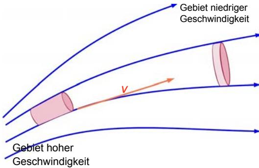
Abbildung 2.145: Stromliniendichte als Maß für die lokale Geschwindigkeit.
