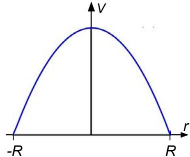
Abbildung 2.165: Geschwindigkeitsprofil bei laminarem Fluss durch ein Rohr.
