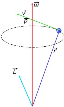
Abbildung 2.72: Drehimpuls  $\vec{L} = \vec{r} \times \vec{p}$ .
