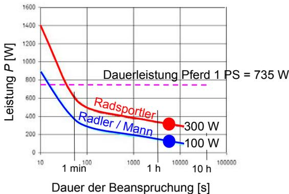
Abbildung 2.46: Leistung als Funktion der Dauer der Beanspruchung.
