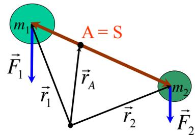
Abbildung 2.83: Gleichgewicht eines starren Körpers.
