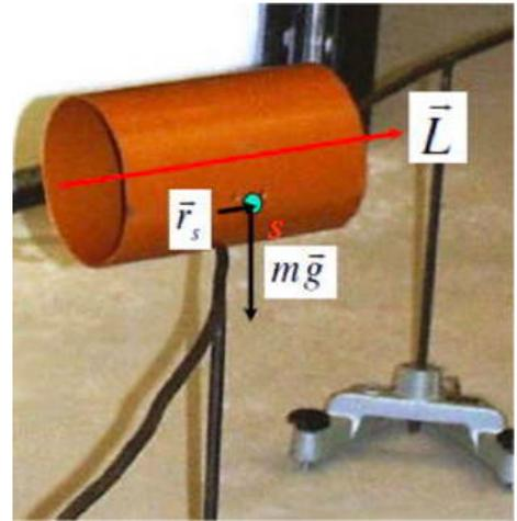
Abbildung 2.91: Ein Zylinder wird durch einen Kreisel stabilisiert und kann so einem dünnen Metallrohr folgen.
