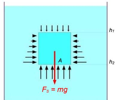
Abbildung 2.122: Berechnung des Schweredrucks.
