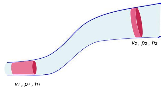
Abbildung 2.156: Beitrag des Schweredruckes zur Bernoulli-Gleichung.
