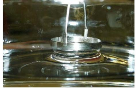
Abbildung 2.134: Experiment Oberflächenspannung.
