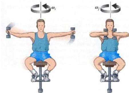
Abbildung 2.86: Erhöhung der Winkelgeschwindigkeit durch Reduktion des Trägheitsmoments.
