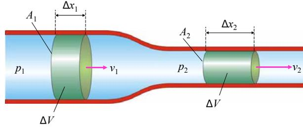
Abbildung 2.150: Transport eines Volumenelementes in einer laminaren Strömung.
