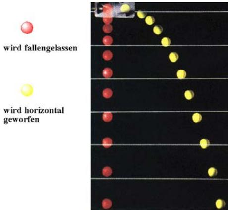
Abbildung 2.13: Unabhängigkeitsprinzip.
