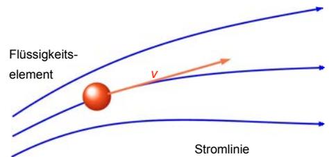
Abbildung 2.144: Darstellung eines Flussfeldes mit Flusslinien.
