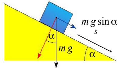
Abbildung 2.28: Gleiten eines Körpers auf einer schiefen Ebene.
