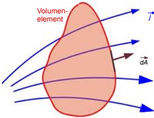
Abbildung 2.149: Massenbilanz für ein Volumenelement.
