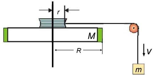
Abbildung 2.81: Experimentelle Bestimmung des Drehmoments.
