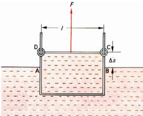
Abbildung 2.133: Berechnung der Oberflächenspannung.
