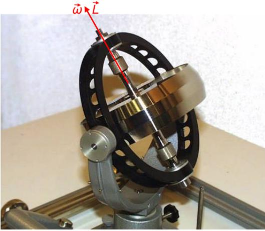
Abbildung 2.90: Kardanisch aufgehängter Kreisel.
