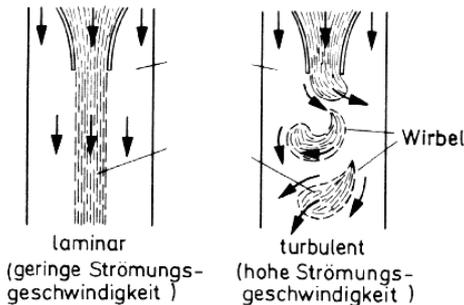
Abbildung 2.168: Einsetzen von Turbulenz.
