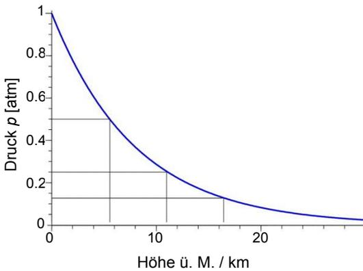
Abbildung 2.125: Atmosphärischer Druck als Funktion der Höhe.
