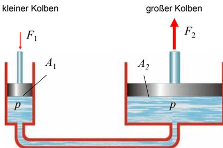
Abbildung 2.120: Hydraulische Presse.
