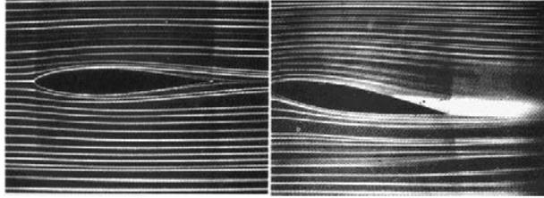
Abbildung 2.170: Strömungsabriss.
