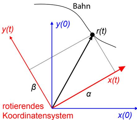
Abbildung 2.106: Bewegung in einem rotierenden Koordinatensystem.
