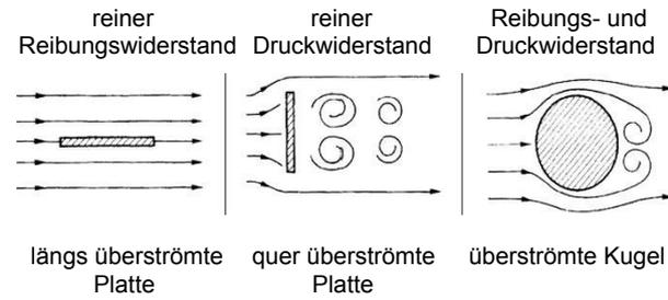
Abbildung 2.160: Widerstand in einer Flüssigkeit.
