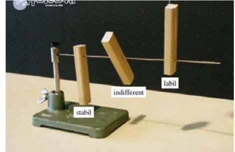
Abbildung 2.84: Stabiles, indifferentes und labiles Gleichgewicht, abhängig vom Aufhängepunkt.
