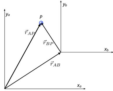
Abbildung 2.100: Ortsvektor  $\vec{r}$  eines Punktes  $P$  in 2 unterschiedlichen Bezugssystemen  $A, B$ .
