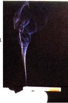
Abbildung 2.148: Laminare und turbulente Strömungen.
