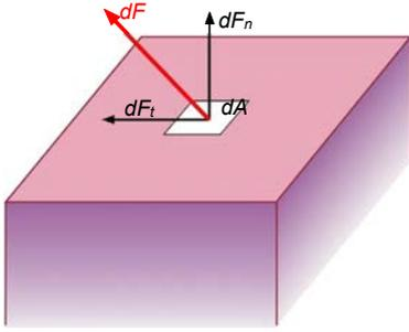
Abbildung 2.117: Spannung als Quotient aus Kraft und Fläche; Zerlegung in Normal- und Schubspannung.
