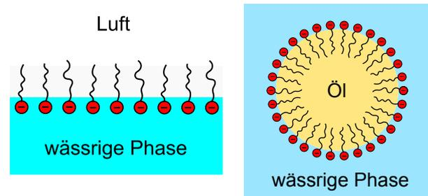
Abbildung 2.137: Tenside an unterschiedlichen Grenzflächen.
