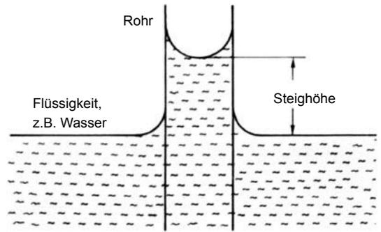
Abbildung 2.141: Kapillarkräfte.
