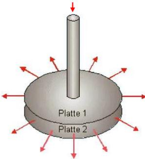
Abbildung 2.157: Strömung zieht Platte an.
