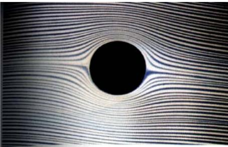
Abbildung 2.146: Laminare Strömung um einen Zylinder.
