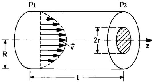
Abbildung 2.164: Durchfluss durch ein zylindrisches Rohr.
