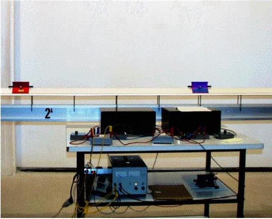
Abbildung 2.63: Elastischer Stoß auf Schiene.
