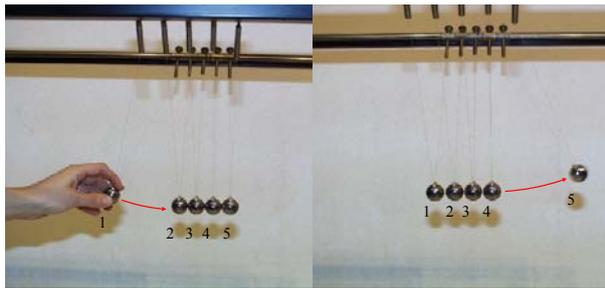
Abbildung 2.66: Stoß an einer Kugelreihe.
