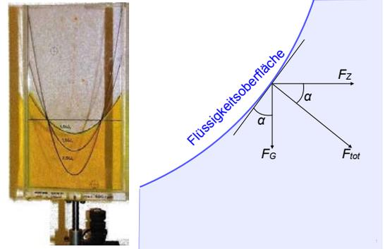
Abbildung 2.118: Flüssigkeitsoberfläche in einer rotierenden Kuvette.
