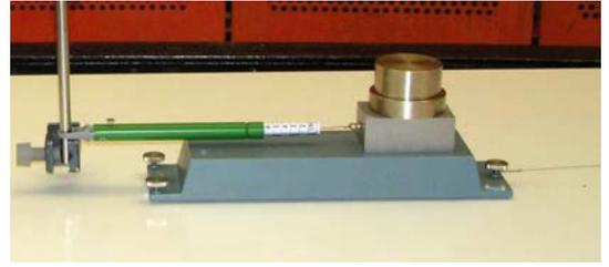
Abbildung 2.29: Messung des Reibungswiderstandes mit Hilfe eines Federkraftmessers.
