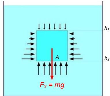
Abbildung 2.126: Auftrieb: der Druck auf die untere Fläche ist größer als auf die obere Fläche.
