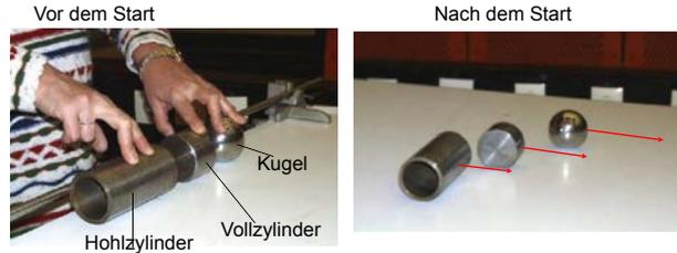
Abbildung 2.78: Rotationssymmetrische Körper auf einer schiefen Ebene.
