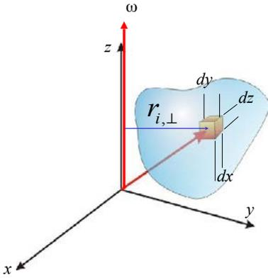
Abbildung 2.74: Trägheitsmomente von beliebigen Körpern durch Integration.
