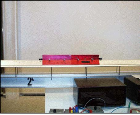
Abbildung 2.67: Unelastischer Stoß.
