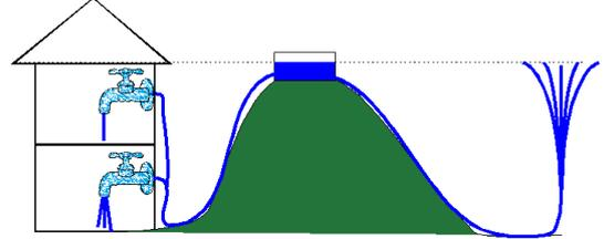
Abbildung 2.124: Druckverteilung im Wasserrohr-Netz.
