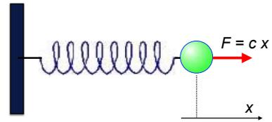
Abbildung 2.44: Federkraft.
