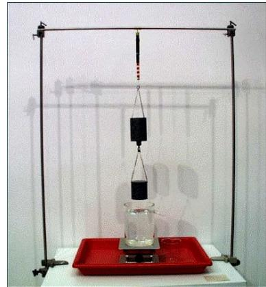
Abbildung 2.129: Messung des Auftriebs.
