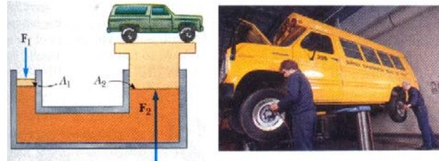
Abbildung 2.121: Hydraulischer Lift.
