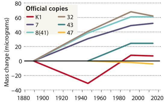
Abbildung 2.21: Variation der gemessenen Masse von unterschiedlichen Kopien des Ur-Kilogramms.
