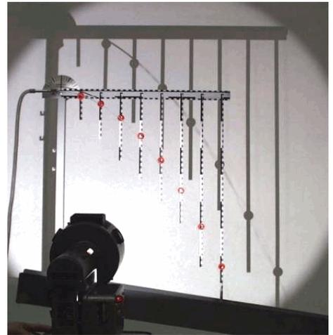
Abbildung 2.12: Wasserstrahlparabel.
