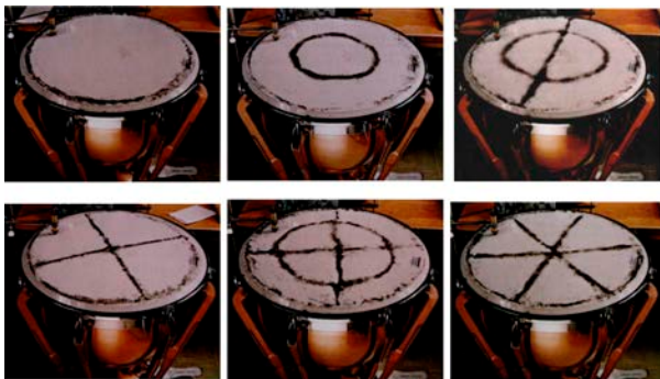
Abbildung 6.37: 6 unterschiedliche Moden als Chladni'sche Klangfiguren [aus Spektrum der Wissenschaft].
