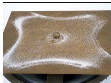
Abbildung 6.35: Beispiel einer Chladni'schen Klangfigur.
