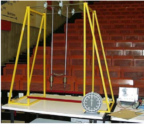
Abbildung 5.50: Zwei gekoppelte Pendel.
