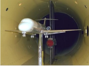
Abbildung 3.22: NASA-Windkanal mit Flugzeugmodell. [3]
