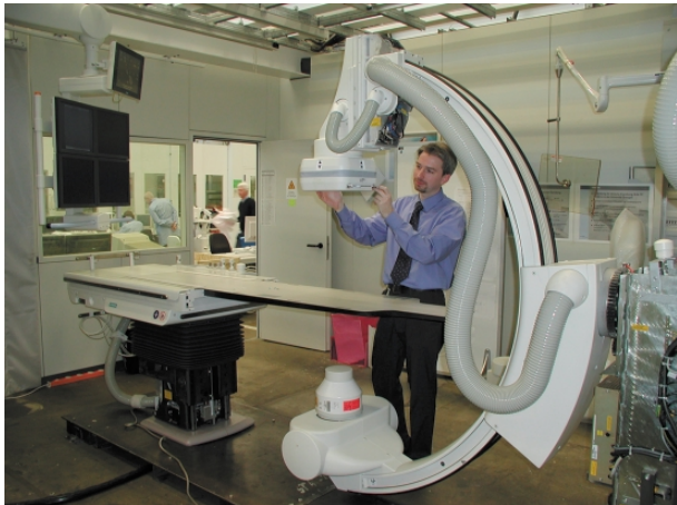
In seiner „Kojen“ testet Burkhard Groh bei Siemens Festkörperdetektoren für Angiographie-Systeme.
