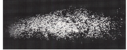
Abbildung 8.34: Kavitationsblasen in einem Ultraschallstrahl.
