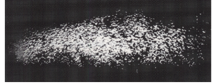
Abbildung 8.31: Kavitationsblasen in einem Ultraschallstrahl. [7]
