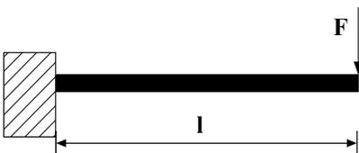
Abbildung 2.29: Einseitig eingespannter Balken mit Punktbelastung am freien Ende.
