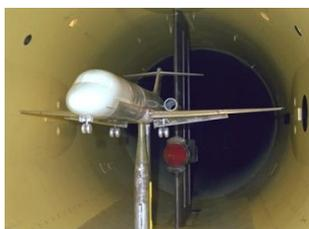
Abbildung 5.42: NASA-Windkanal mit Flugzeugmodell. [4]
