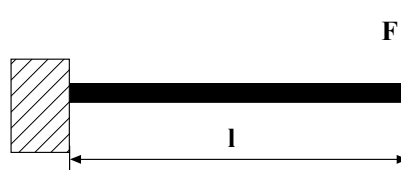
Abbildung 4.35: Einseitig eingespannter Balken mit Punktbelastung am freien Ende.
