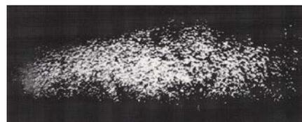
Abbildung 14.62: Kavitationsblasen in einem Ultraschallstrahl.
