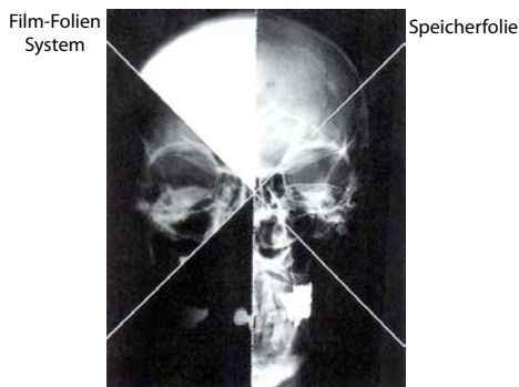
Abbildung 12.45: Vergleich der Bilder von einem Film-Folien System mit dem einer Speicherfolie.
