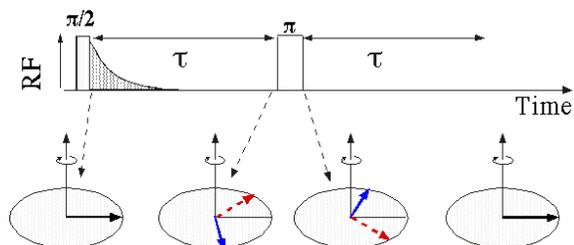
Abbildung 4.9: Pulssequenz für das Hahn-Echo Experiment.
