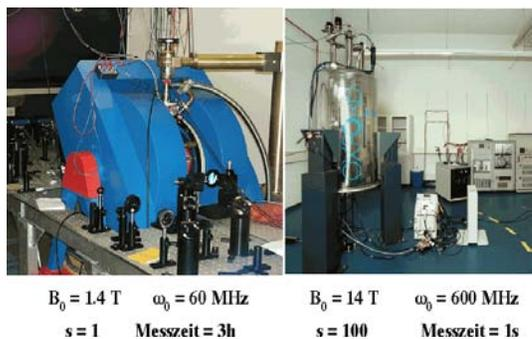
Abbildung 4.4: Unterschiedliche Feldstärken für die NMR und die entsprechenden Empfindlichkeiten und Messzeiten.
