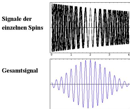
Abbildung 4.12: Bildung des Echos: Zur Zeit des Echos sind alle Phasen identisch (=0).
