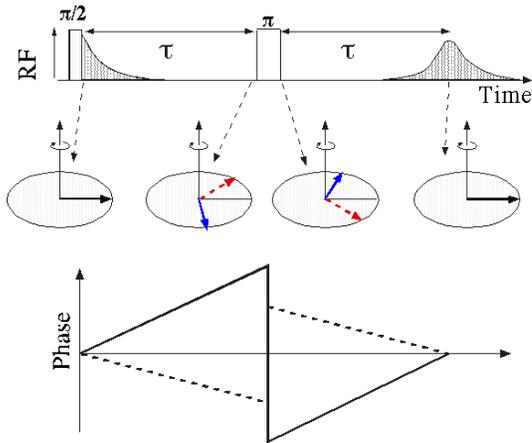
Abbildung 4.11: Inversion der Phasen durch den Refokussierungspuls.
