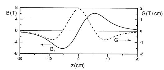
Dortmunder Hochfeld-Spektrometers sieht man, dass man bei ca. 9 Tesla einen Gradienten im Bereich von G = 70 T/m erzielen kann. Noch größere statische Gradienten erhält man, indem man eine sogenannte Anti-Helmholtz-Anordnung,
