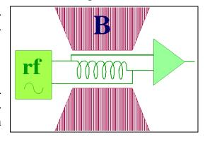
Die Resonanzfrequenz der Spins hängt nicht nur von der Stärke des Magnetfeldes, sondern auch von der Art des Spins (Kern / Elektron) und von seiner Umgebung ab.
