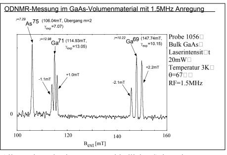
betrachtet werden müssen. Im Allgemeinen besitzen unterschiedliche Spins einen unterschiedlichen Spin und immer ein anderes gyromagnetisches Verhältnis. Dass die Resonanzlinien der beiden Ga Isotope aufgespalten sind ist auf die Kern-Quadrupol-Wechselwirkung zurückzuführen.
