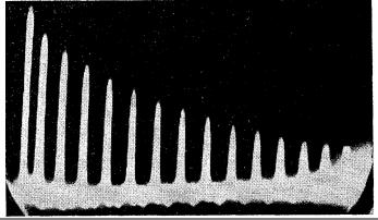
Diese Mehrfachechos wurden von Carr und Purcell eingeführt (H.Y. Carr, and E.M. Purcell, 'Effect of diffusion on free precession in neulear magnetic resonance experiments', Phys.Rev. 94, 630 (1954).) und von Meiboom und Gill verbessert.
