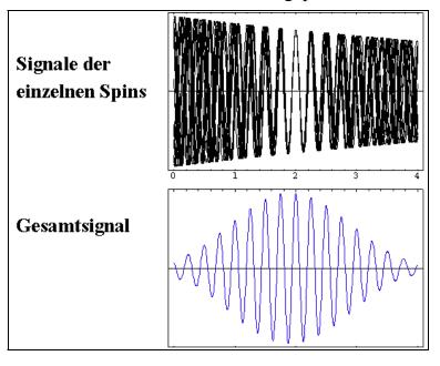
alle Spins vorhanden, auch in einem homogenen Feld und wird deshalb als homogener Beitrag zur Relaxation respektive zur Linienbreite bezeichnet.
