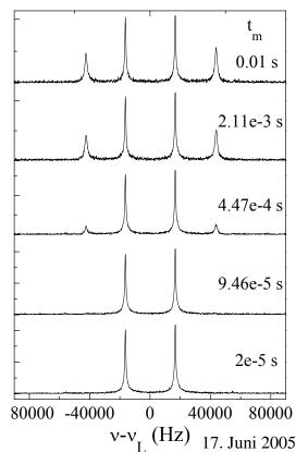
größerer Anteil der Magnetisierung mit der für  $t_m \rightarrow 0$  fehlenden Frequenz.
