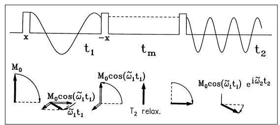
kann man erreichen, indem man den zweiten Puls (beispielsweise der Hahn-Echo-Sequenz) gewissermaßen in zwei Teile zerlegt. Die Dreipuls-Sequenz, die man dadurch erhält, ist von besonderer Bedeutung nicht nur für die Echospektroskopie, sondern insbesondere auch für die zweidimensionale Austauschspektroskopie.
