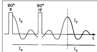
Wenn also die Zeitentwicklung ab dem Echozeitpunkt genauso verläuft wie nach dem ersten Puls, dann kann man damit die nach einem Puls durch eine Übersteuerung der Vorverstärker meist auftretende "Totzeit" des Empfängers umgehen.
