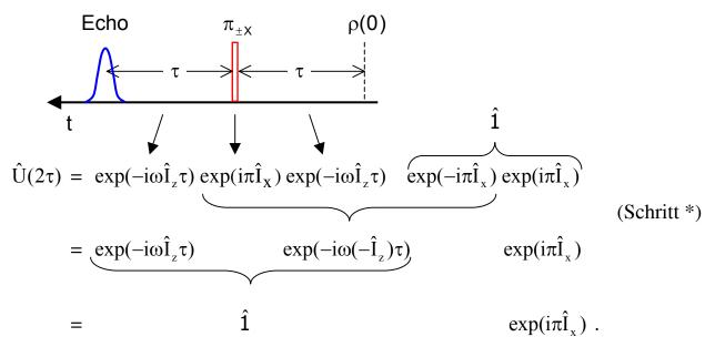
Damit ist der gesamte Propagator auf den Pulspropagator reduziert, die Zeemanwechselwirkung verschwindet insgesamt. Wir hätten dasselbe Ergebnis erhalten, wenn wir eine Drehung um 180° um eine beliebige Achse in der xy-Ebene durchgeführt hätten.
