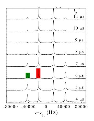
Als Funktion der Evolutionszeit zeigt die "abgespeicherte" Magnetisierung eine Amplitudenmodulation, die beispielsweise durch  $M_0 cos \omega_1 t_1$  gegeben ist. Dies kann man direkt nachweisen, indem man mit einem dritten  $90^\circ$  Puls die gespeicherten Komponenten "abfragt". Dabei muss man allerdings die Mischzeit  $t_m$  so kurz wählen, dass während dieser Zeitspanne keine Austauschprozesse stattfinden können.
