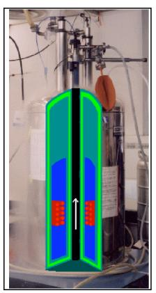
Dieses Prinzip funktioniert natürlich nur bis die Sättigungsfeldstärke des Eisens erreicht ist. Man erreicht damit Feldstärken von maximal etwa 2 T. Wesentlich stärkere Felder, bis zu etwa 20 T, erreicht man mit supraleitenden Magneten, also Spulen aus supraleitendem Draht, durch die ein konstanter Strom fließt.
