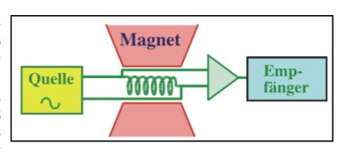
selspannung, welche dieses Feld erzeugt, wird von einem Radiofrequenz-Synthesizer erzeugt. In den meisten Fällen wird das vom Synthesizer erzeugt Signal nicht direkt auf die Probe gebracht, sondern zunächst von Schaltern, Verstärkern, Phasenschiebern etc. aufbereitet.
