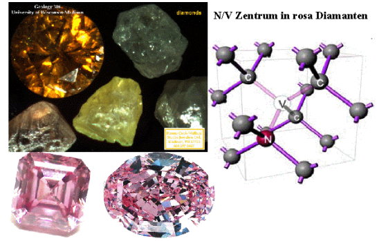
Abbildung 4.28: Farbige Diamanten und Struktur des N/V Zentrums, das für die Farbe in den rosa Diamanten sorgt.
