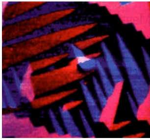
Abbildung 8.76: Weiß'sche Bezirke beobachtet im Polarisationsmikroskop.
