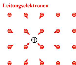
Abbildung 5.36: Abschirmung einer positiven Ladung durch die Leitungselektronen.
