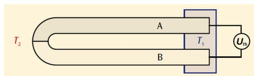
Abbildung 2: Schematische Darstellung eines Thermoelements
