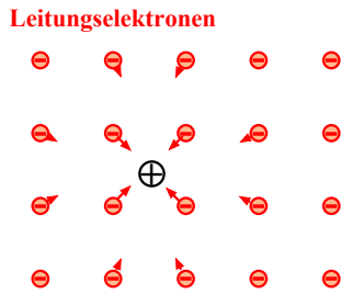
Abbildung 5.36: Abschirmung einer positiven Ladung durch die Leitungselektronen.
