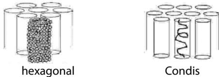
Abbildung 2.8: Partielle Positionsfernordnung in Flüssigkristallen.
