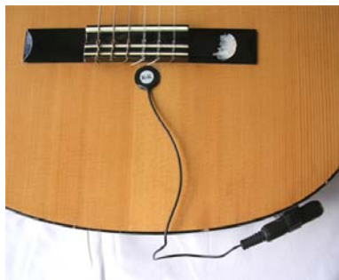
Abbildung 12.10: Mikrofon, welches den Piezo-Effekt verwendet.
