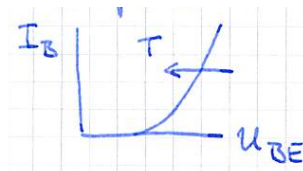
Abbildung 7.2: Verschiebung der Kennlinie als Folge einer Temperaturerhöhung.
