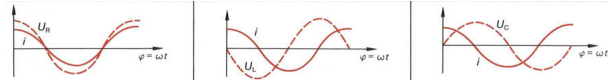
Abbildung 2.5: Phasenverschiebung zwischen Strom und Spannung für Widerstand (links), Spule (mitte) und Kondensator (rechts).
